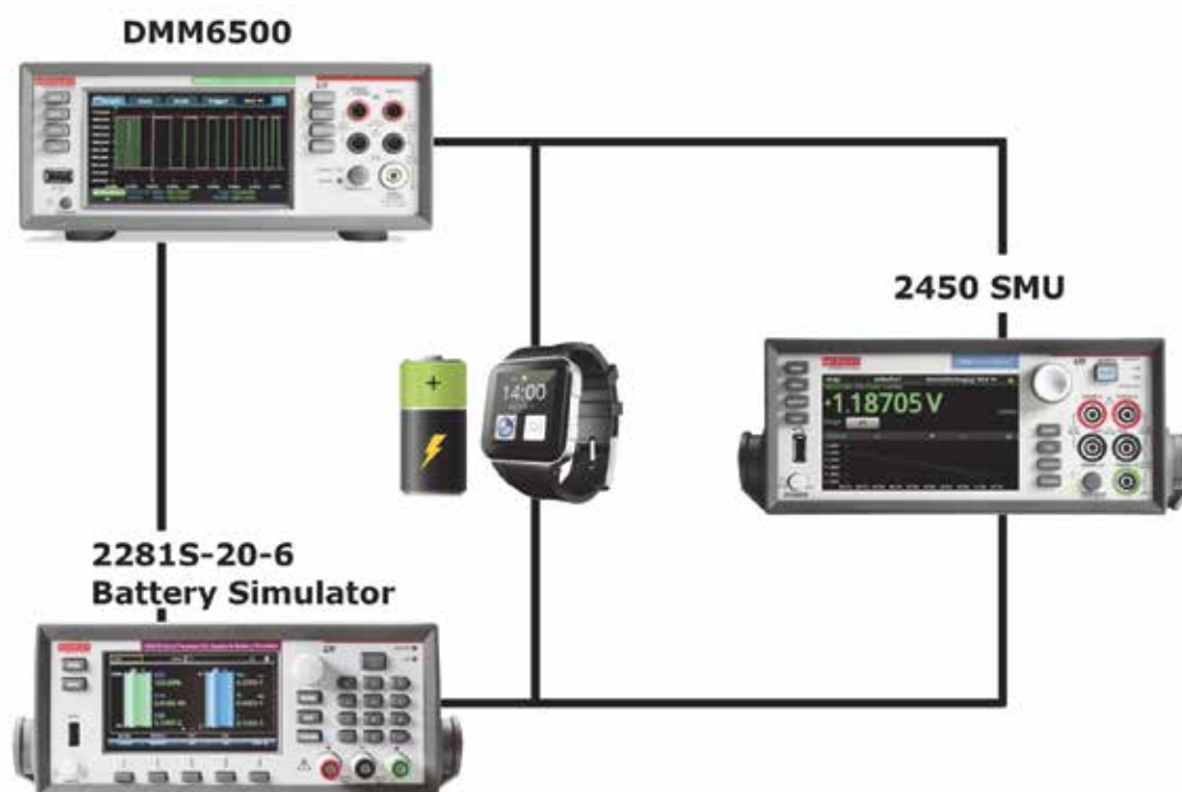
En strømprofil af et smartwatch-batteri kan skabes med et DMM6500 multimeter, en 2281S-20-6 batterisimulator og en 2450 SMU strømforsyning, alle fra Keithley.
